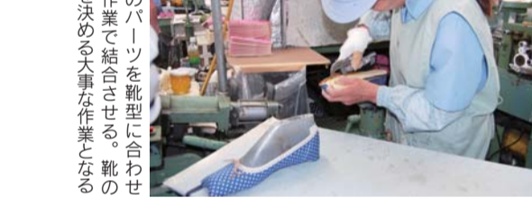
▶甲のパーツを靴型に合わせて手作業で結合させる。靴の表情を決める大事な作業となる
