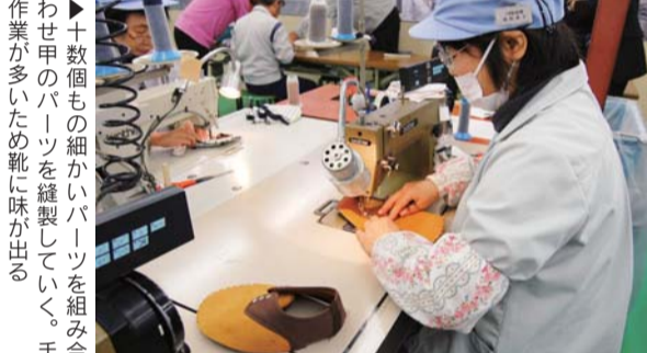
▶十数個もの細かいパーツを組み合わせて甲のパーツを縫製していく。手作業が多いため靴に味が出る
