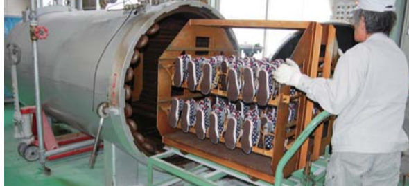
▲生ゴムに硫黄を混ぜ、釜で130度の熱と圧力を加えゴム底と靴本体を同時に接着・成型することで、適度な弾性と強度を生む。このバルカナイズ製法は国内で4社しか行っていない
