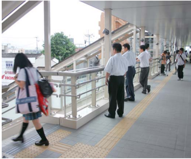
▲歩道橋の延長は65m、幅は3.5m。雨天時もぬれずに乗り換えてできる
