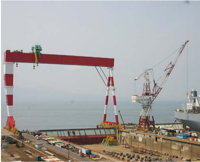
▲1号ドック(620m)に据え付けられた1号機。8月に右の2号ドック(420m)にも設置する
