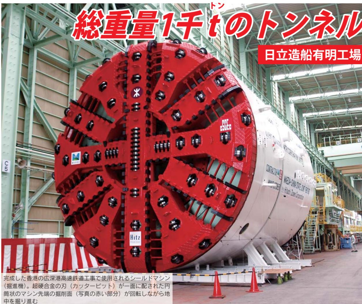
完成した香港の広深港高速鉄道工事に使用されるシールドマシン（掘進機）。超合金の刃（カッタービット）が一面に配された円筒状のマシン先端の掘削面（写真の赤い部分）が回転しながら地中を掘り進む
