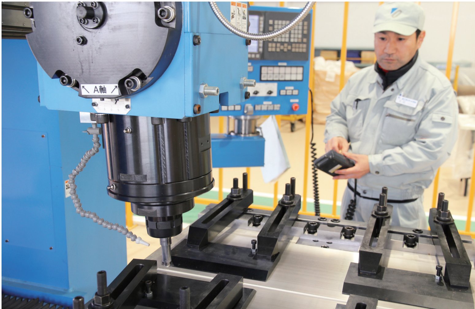
▲不二ライトメタルの「先端技術・実証評価設備工場」内に導入した熊大 Mg の接合設備。回転軸の摩擦熱でマグネシウム板を接合する。工場の総事業費は8億5千万円。研究開発員8人を含む18人体制で量産に向けた課題解決に取り組む
