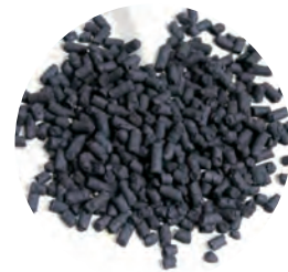
▲同施設で製造された固形燃料。低温炭化燃料化方式により、高発熱量、低自然発火性、低臭気という特徴を持つ
