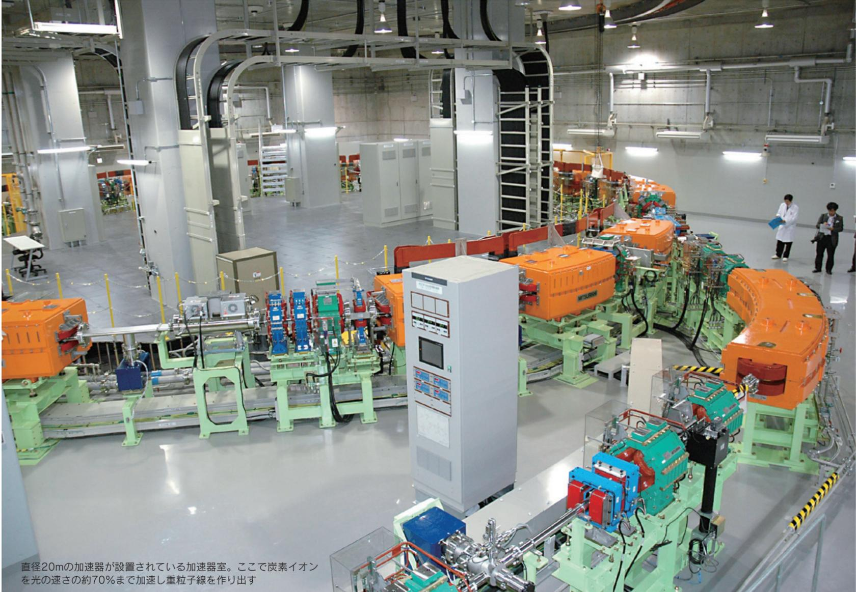
直径20mの加速器が設置されている加速器室。ここで炭素イオンを光の速さの約70%まで加速し重粒子線を作り出す
