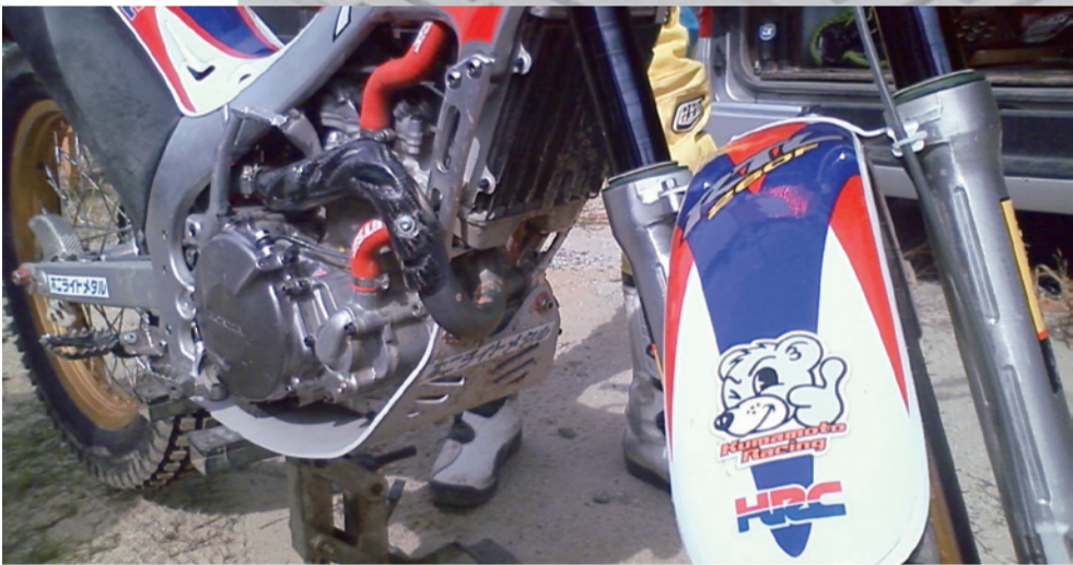
▲不二ライトメタル(株)（玉名郡長洲町、中重健治社長）では、「KUMADAI耐熱マグネシウム合金」の実用化研究が進む。同社では本田技研熊本製作所オートバイ部と連携、トライアル競技用バイクに同合金製の部品を搭載して実証・評価試験を行なっている。写真のバイクのエンジン下部の「エンジンガード」と後輪の「チェーンアジャスター」がKUMADAI耐熱マグネシウム合金
