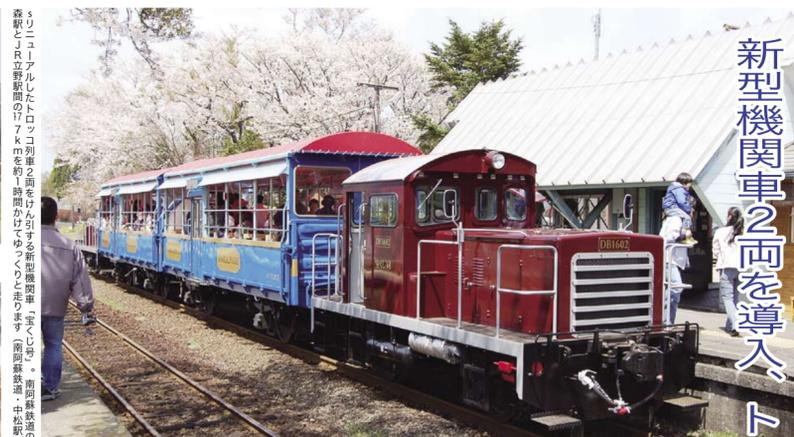
自然風景の豊かな南阿蘇をのびのびと旅したい。そんな思いを叶えるべく、阿蘇高森町の南阿蘇鉄道は、観光トロッコ列車をけん引する新型機関車2両を導入、3月24日から運行を開始しました。新型機関車2両は、1両4200万円、全額を日本まじり協会の助成金で賄っています。国鉄時代から使用してきた旧型の約3倍の力を持ち、3面のトロッコ客車(44人乗り)をけん引することが可能で、リニアール自動ドアを導入し、雨天時用のポリカーボネート製の簡易窓と扇風機を設置。座席も3人掛けから2人掛けになり、ゆったり。別に客車1両も新造中で、補修・新造費の合計は3550万円。同社の津留恒一社長は「06年度は約3万2千人のお客さまが利用しました。ピーク時には満席となることも多いため、今年大型連休には新造中の客車を加えた3両で運行したいですね。トロッコ列車は11月30日まで土日祝日運行ですが、春・夏休み、大型連休は毎日運行しています。」
